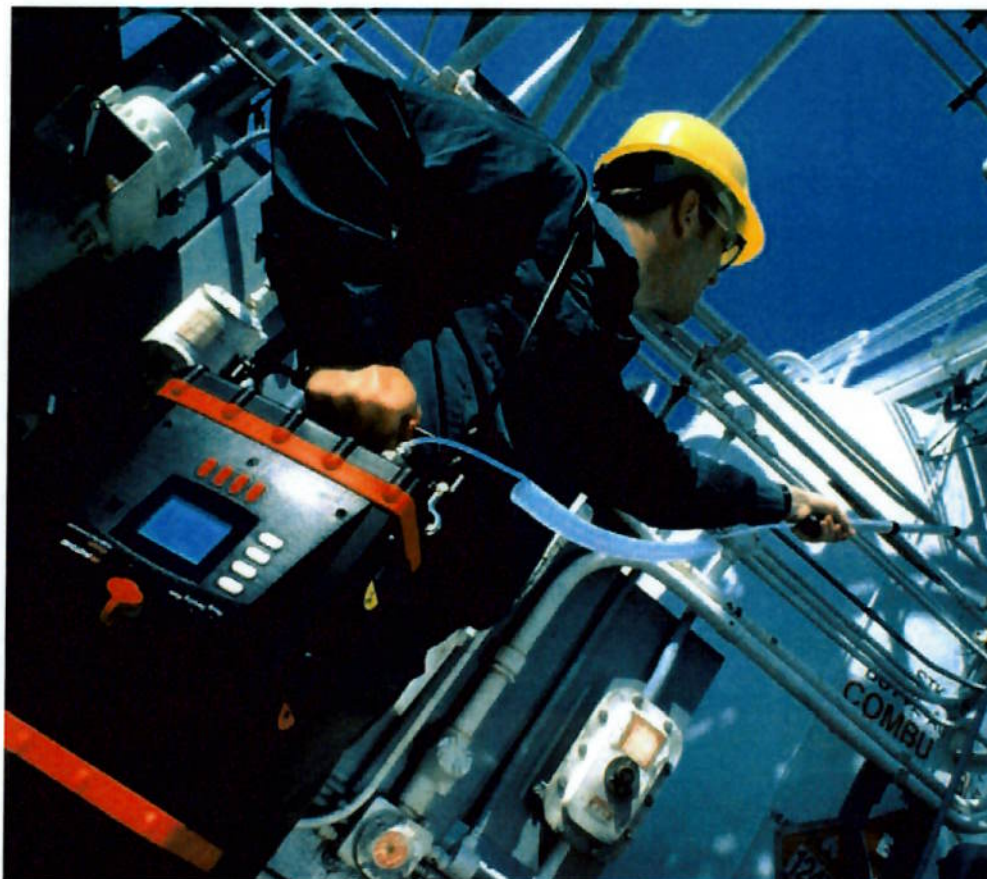
Figura 5 – Voyager com sonda telescópica (PHOTOVAC, 2008)
